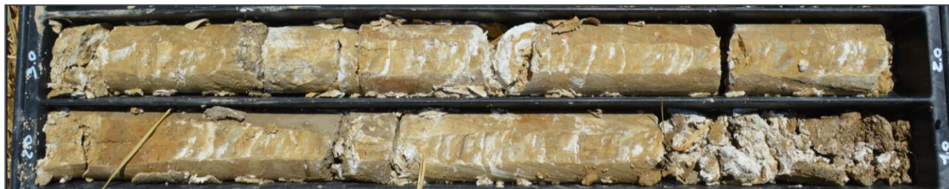
Figura 8– Argille limose carbonatiche provenienti da sondaggio eseguito in agro di San Gavino
