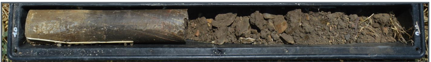
Figura 5 – Argille limose organiche grigio scuro provenienti da un sondaggio eseguito in agro di San Gavino.
