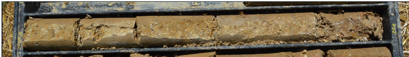
Figura 6 – Ghiaie ciottolose in matrice limo-argillosa provenienti da un sondaggio eseguito in agro di San Gavino
