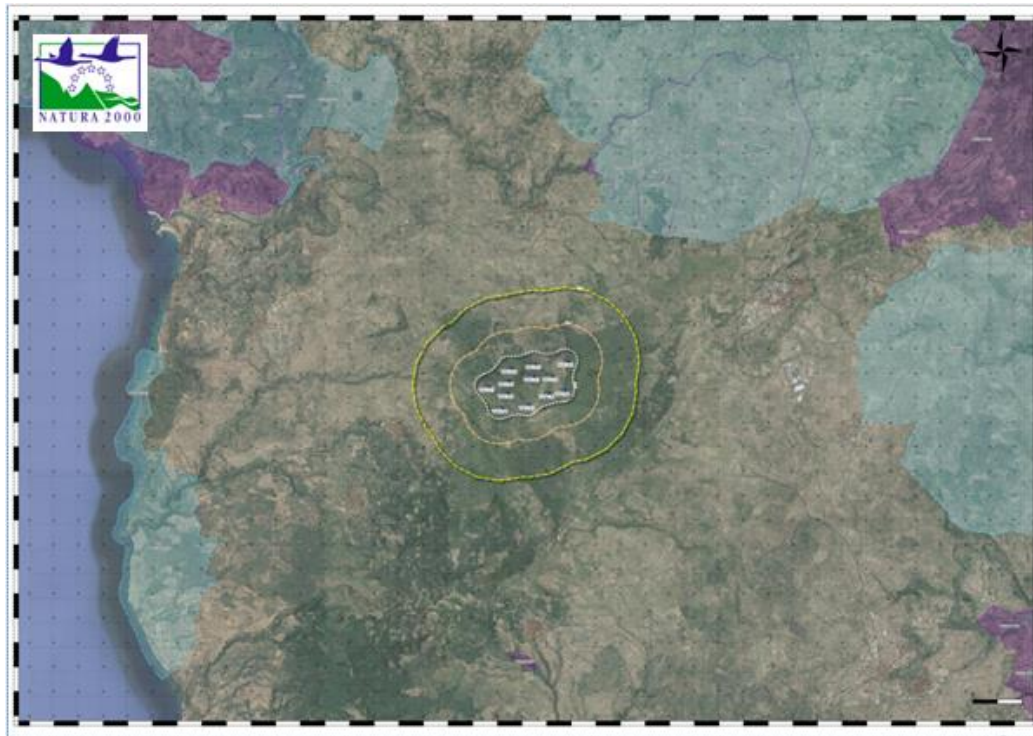
Figura 6. Stralcio fuori scala della Carta della Rete Natura 2000 nell'Area Vasta del Progetto di Parco Eolico "CRASTU FURONES" nel Comune di Scano di Montiferro (OR). Sono evidenziati i buffer di monitoraggio oggetto dei diversi studi faunistici (limiti di raggio da 500 metri a 3000 metri intorno a ciascuno dei proposti aerogeneratori).
