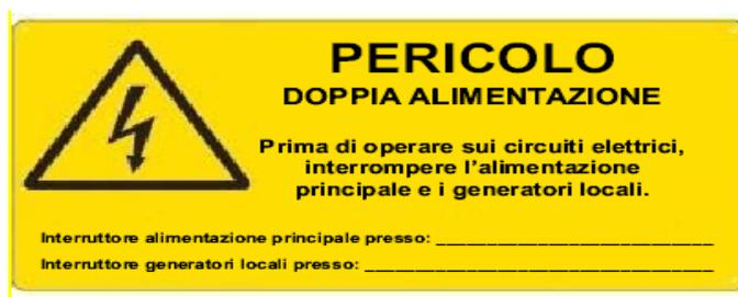
Figura 10.10 - Segnaletica da utilizzare per i lavori sugli impianti FV
