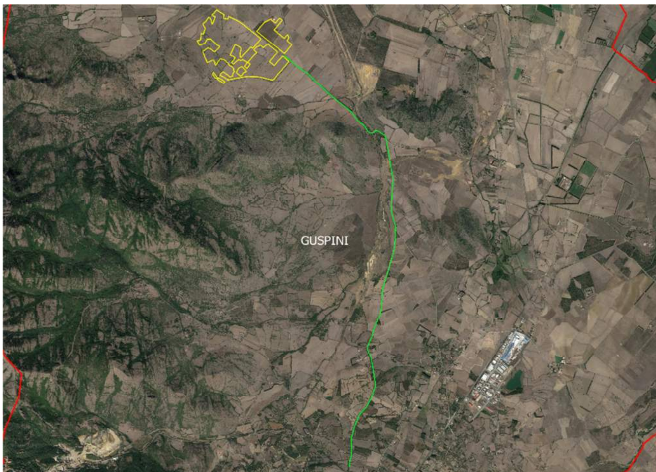
Figura 6 - Area di impianto (in giallo) e cavidotto MT a 36 kV (in verde)
