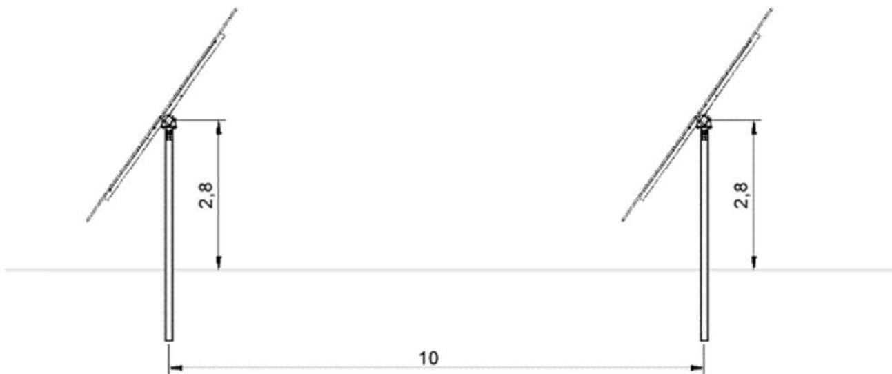
Figura 3 - Tracker o inseguitore monoassiale
