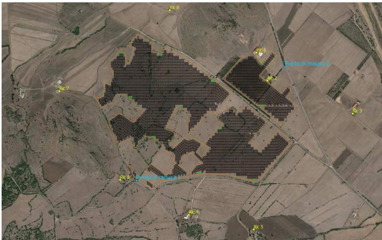
Figura 3-125- Planimetria con indicazione del punto di misura (evidenziato con colore ciano)
