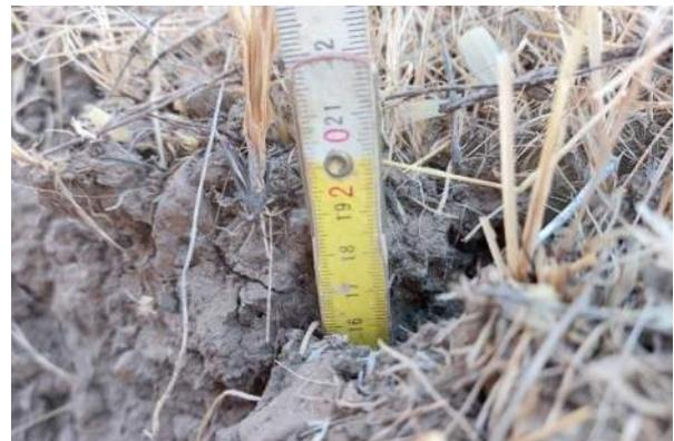
Figura 3-28 – Dettaglio larghezza e profondità di una delle svariate fessurazioni superficiali rilevate
