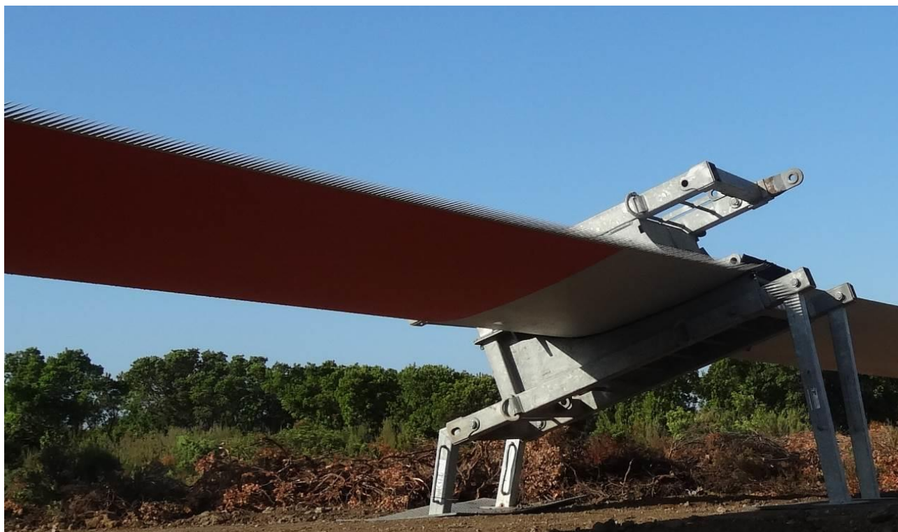
Figura 44: pala di aerogeneratore con bande dentellate.
