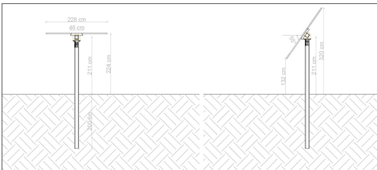
FIGURA 33 – TRACKER TIPO AD ASSE VARIABILE
