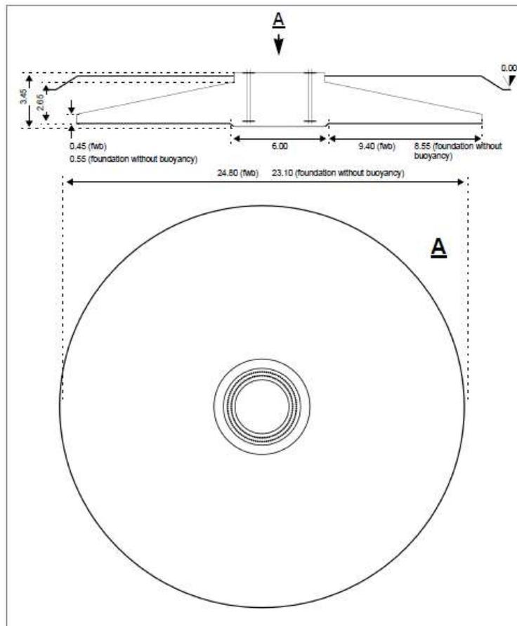
Tav.1 - Schema della fondazione dell'aerogeneratore
