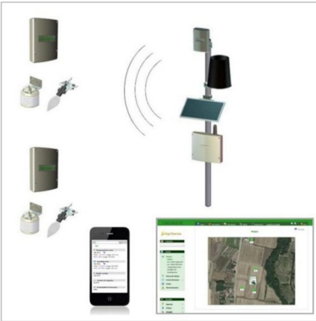
Figura n.7: Stazione principale e sensori meteo climatici.
