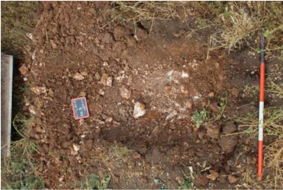
Fig. 7: pozzetto geognostico Pz3 (prof. 0,00 – 0,20 m).
