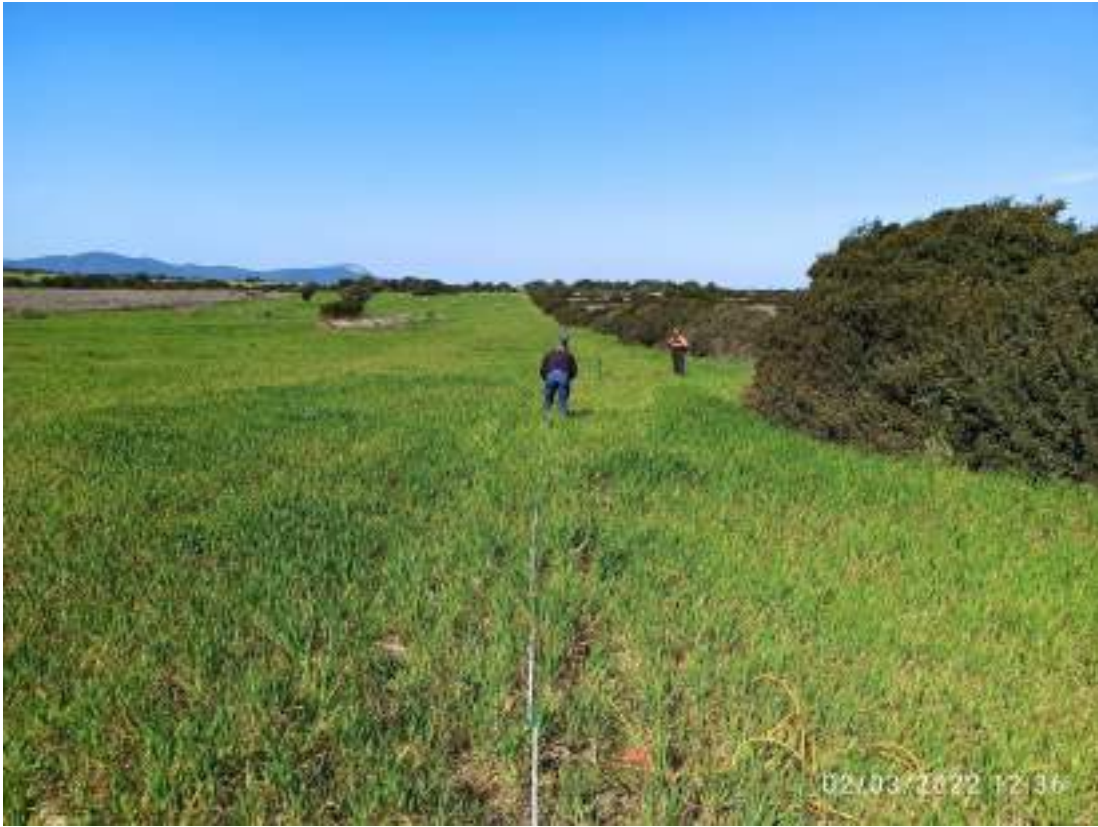
Fig. 49: panoramica stendimento MASW su area “stazione elettrica”.
