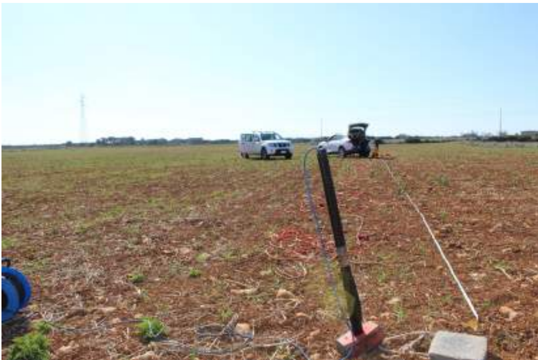
Fig. 48: panoramica stendimento MASW su area “Campo agro fotovoltaico”.
