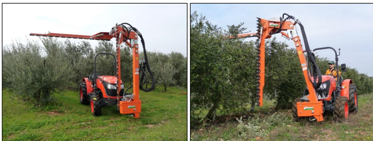
Figura 11.3 - Esempio di potatrice meccanica frontale a doppia barra (taglio verticale + topping) utilizzabile su tutti le colture arboree intensive e superintensive (Foto: Rinieri S.r.l.)
