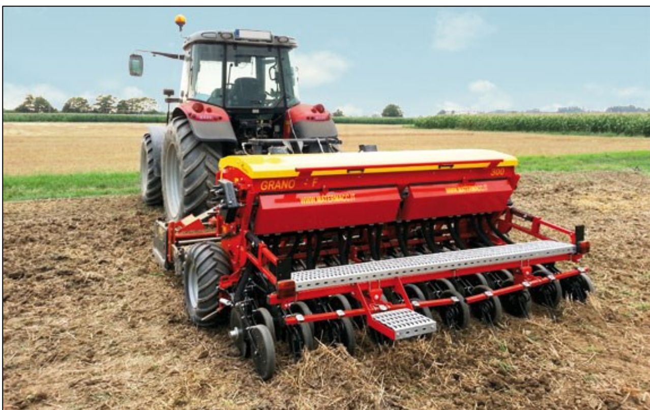
Figura 10.5 - Esempio di seminatrice di precisione per tutte le tipologie di sementi (Foto: MaterMacc S.p.a.)
