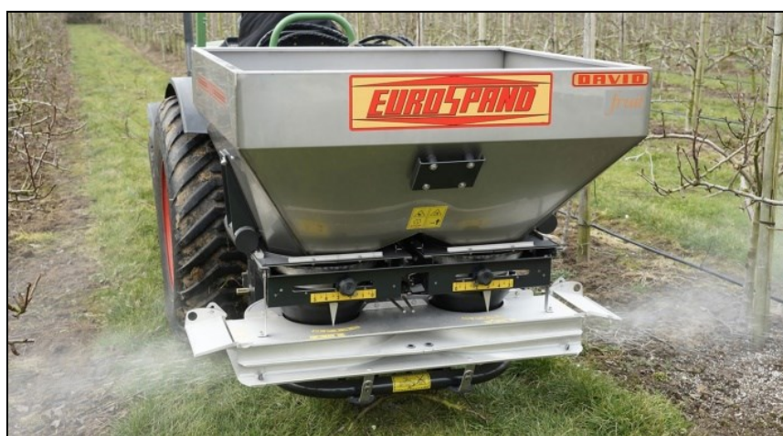
Figura 11.4 - esempio di spandiconcime localizzato mono/bilaterale per frutteti (Foto: EuroSpand)
