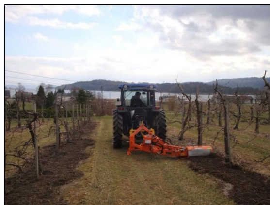
Figura 9.3 - Esempio di fresatrice interceppo per le lavorazioni sulla fila (Foto: Rinieri S.r.l.)
