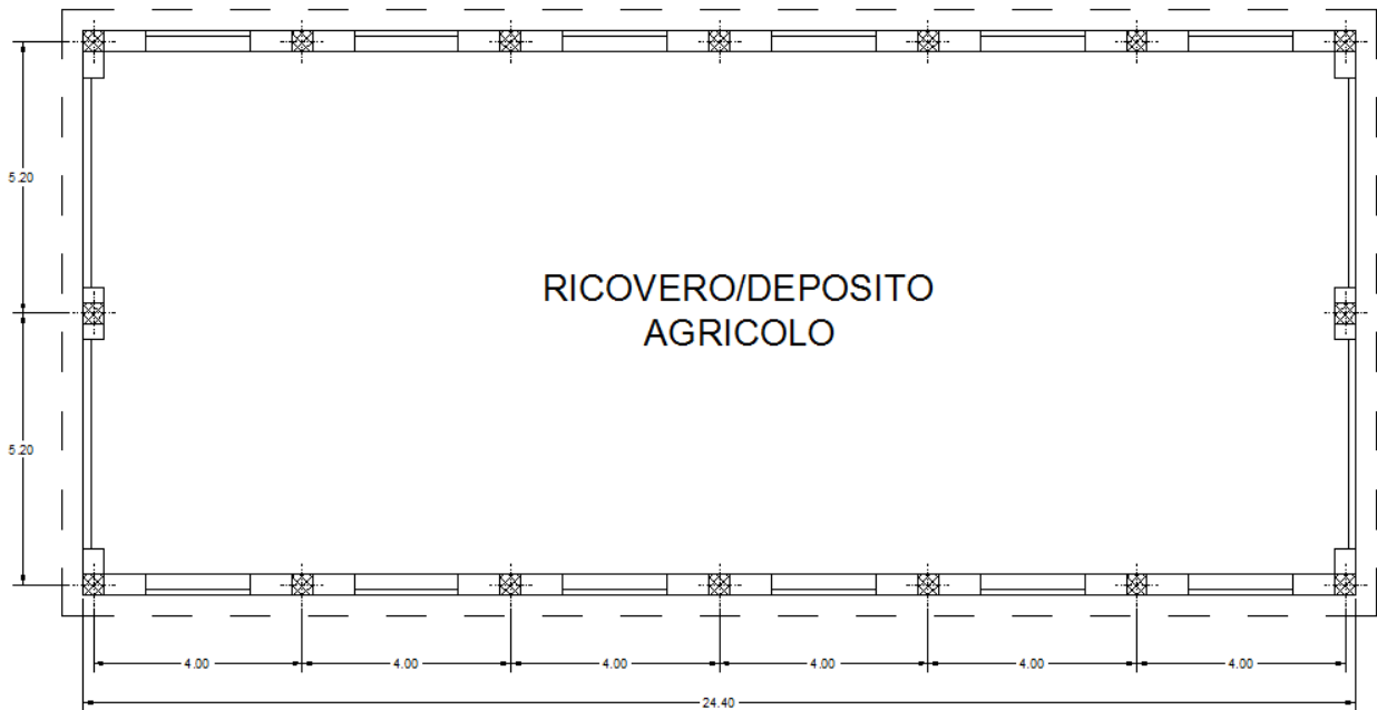
Figura 7.2: Pianta edificio ricovero mezzi agricoli
