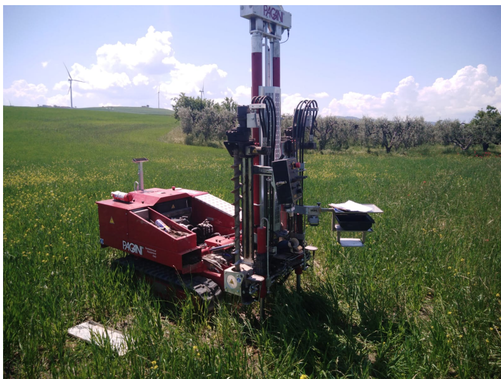
Prova Penetrometrica Dinamica Pesante DPSH 01
