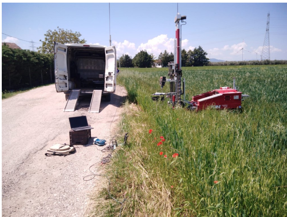
Prova Penetrometrica Dinamica Pesante DPSH 04
