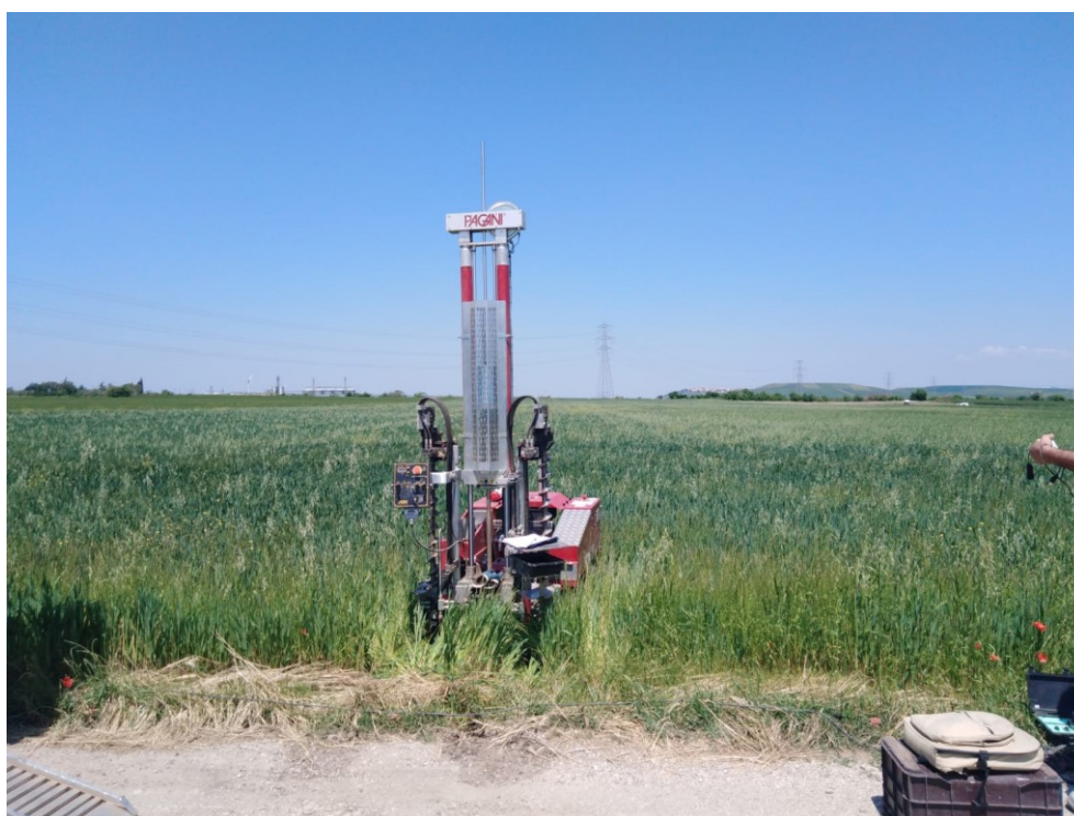
Prova Penetrometrica Dinamica Pesante DPSH 02
