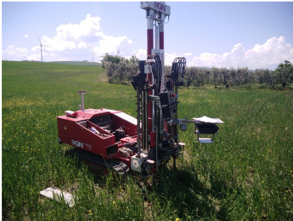
Prova Penetrometrica Dinamica Pesante DPSH 01
