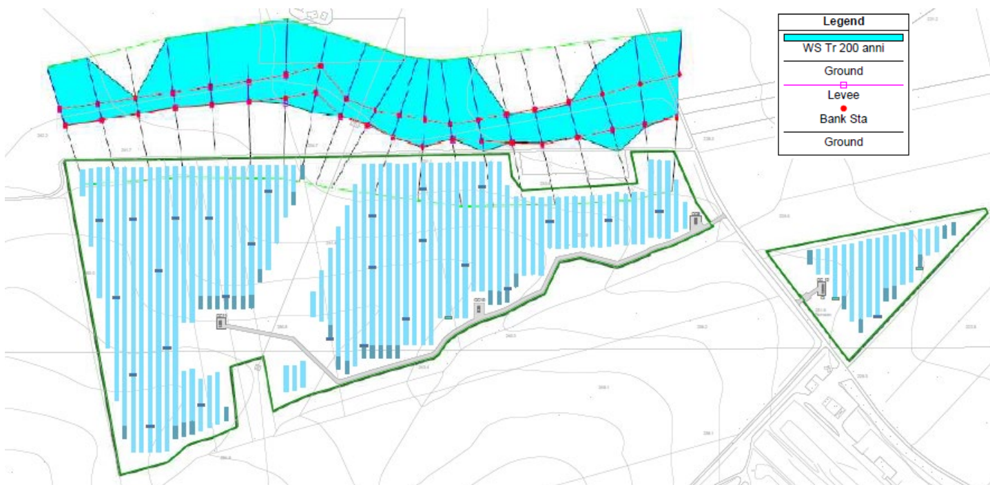
Figura 10 - Planimetria con le sezioni trasversali e le aree di alluvionamento per portate con TR_200_Canale Nord
