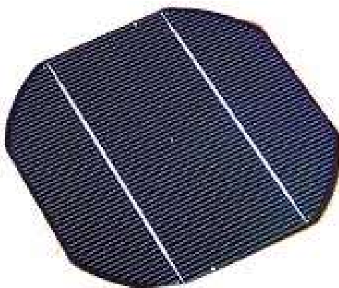
Figura 2.1: Cella fotovoltaica in silicio monocristallino.
