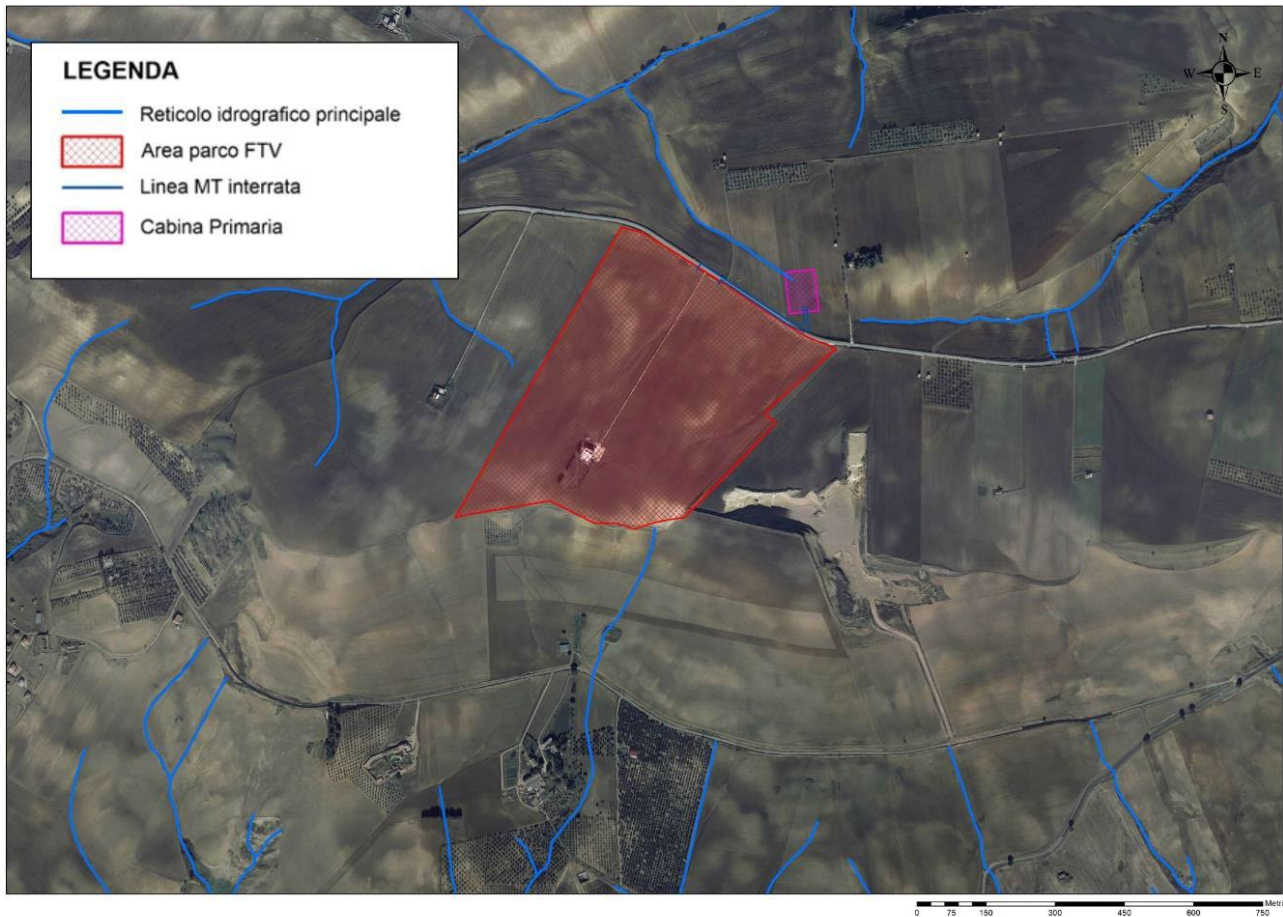
Figura 2. Principali linee di deflusso delle acque superficiali (reticolo idrografico principale) visibili dall'aerofotogrammetria nell'area di progetto
