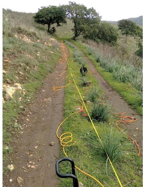
Tomografia Elettrica e Sismica a Rifrazione/Masw
