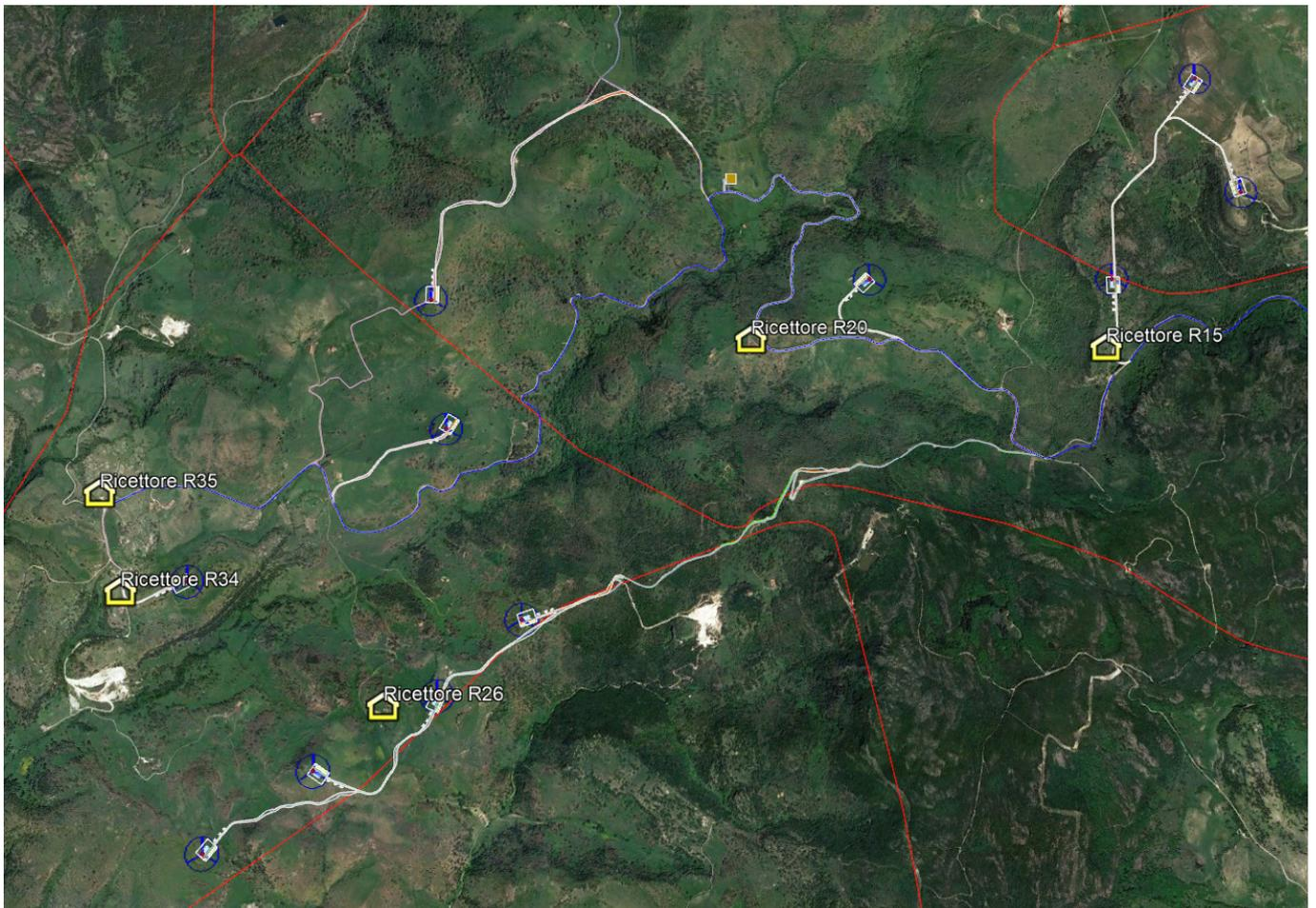
Figura 4 Ricettori di cantiere relativi all'area parco, alla viabilità e ai cavidotti
