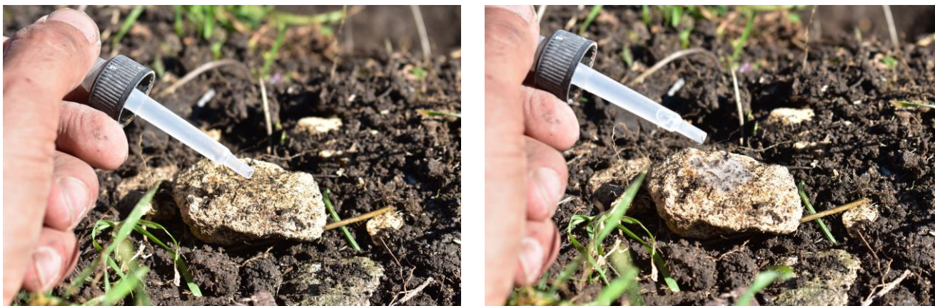
Figura 9 – Piccola clasto carbonatica sottoposto alla prova con l'acido, è visibile una netta reazione.
