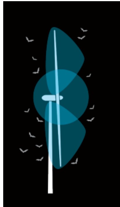
Figura 49. Il Bat Deterrent System della NGR Systems Inc., Hinesburg, Vermont (USA), interferisce con le capacità di ecolocalizzazione dei pipistrelli, su cui si basano per l'orientamento, il foraggiamento e la comunicazione, provocandone il disorientamento e quindi l'allontanamento dall'area "trattata" e che riguarda lo spazio aereo che circonda il rotore e le pale in movimento.
