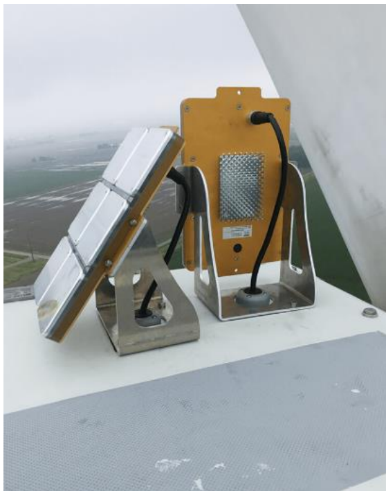
Figura 49. Il Bat Deterrent System della NGR Systems Inc., Hinesburg, Vermont (USA), interferisce con le capacità di ecolocalizzazione dei pipistrelli, su cui si basano per l'orientamento, il foraggiamento e la comunicazione, provocandone il disorientamento e quindi l'allontanamento dall'area "trattata" e che riguarda lo spazio aereo che circonda il rotore e le pale in movimento.
