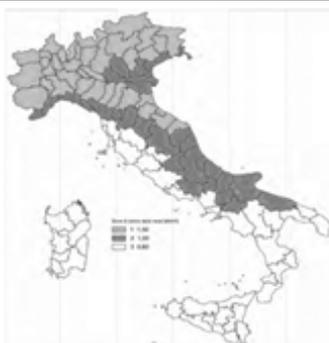
Per altitudini superiori a 1500 m sul livello del mare si fa riferimento alle condizioni locali di clima e di esposizione utilizzando comunque valori di carico neve non inferiori a quelli previsti per 1500 m.
