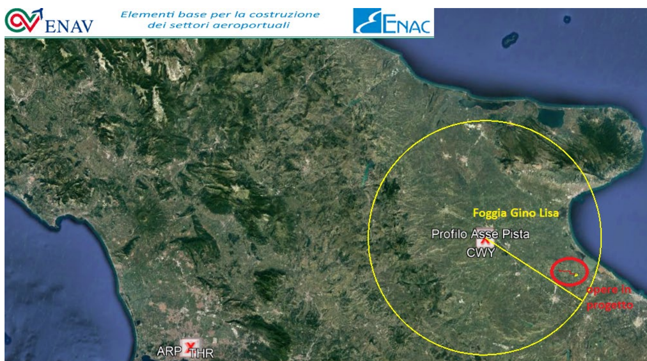
Figura 1 – Determinazione distanza delle opere in progetto rispetto all'aeroporto Foggia Gino Lisa (il cerchio in giallo indica il limite del settore 5 [45 km])
