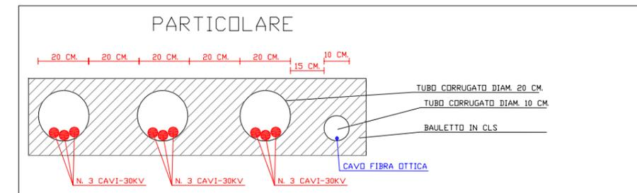
SI PRECISA CHE E' PREVISTO DI POSARE IL CAVIDOTTO A CM. 80 DAL PIANO STRADALE CON PROTEZIONE DELLA TUBAZIONE IN CLCESTRUZZO
