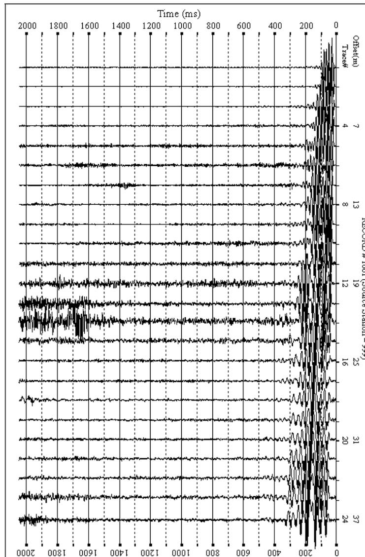
***Fig. 1 – Sismogramma ottenuto.***
