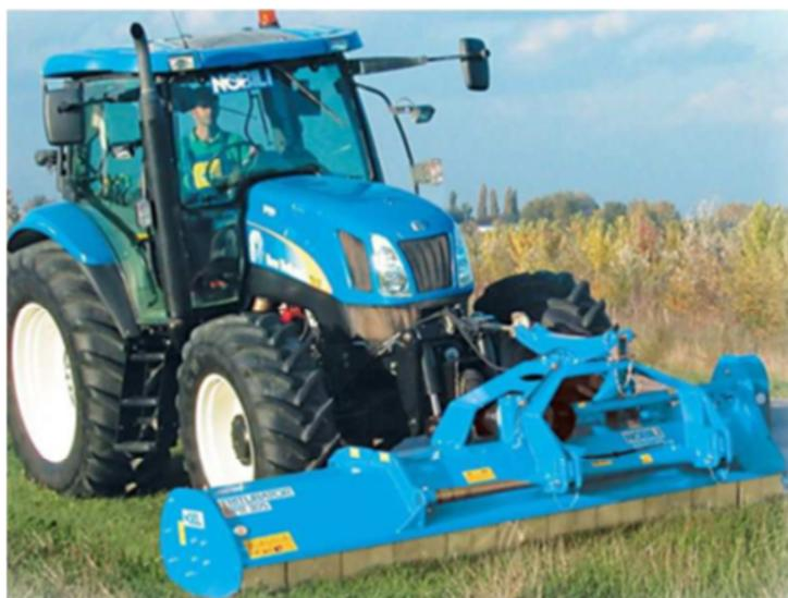
Figura 13 - Trattore con trinciatrice
