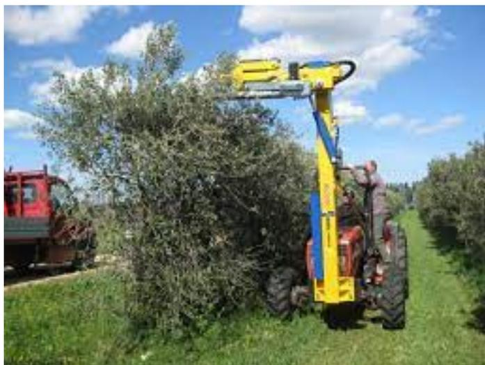
*Figura 6 - Cimatrice per la potatura meccanica*
