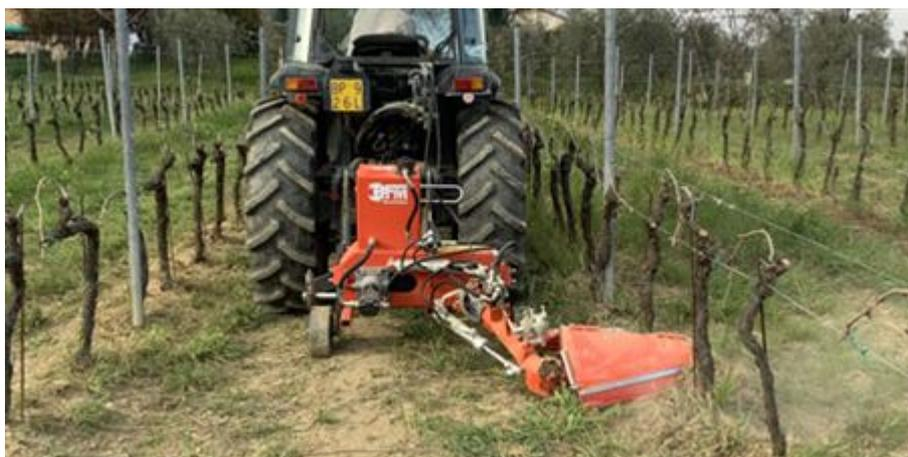
*Figura 4- Fresatrice orizzontale tra le fila*
