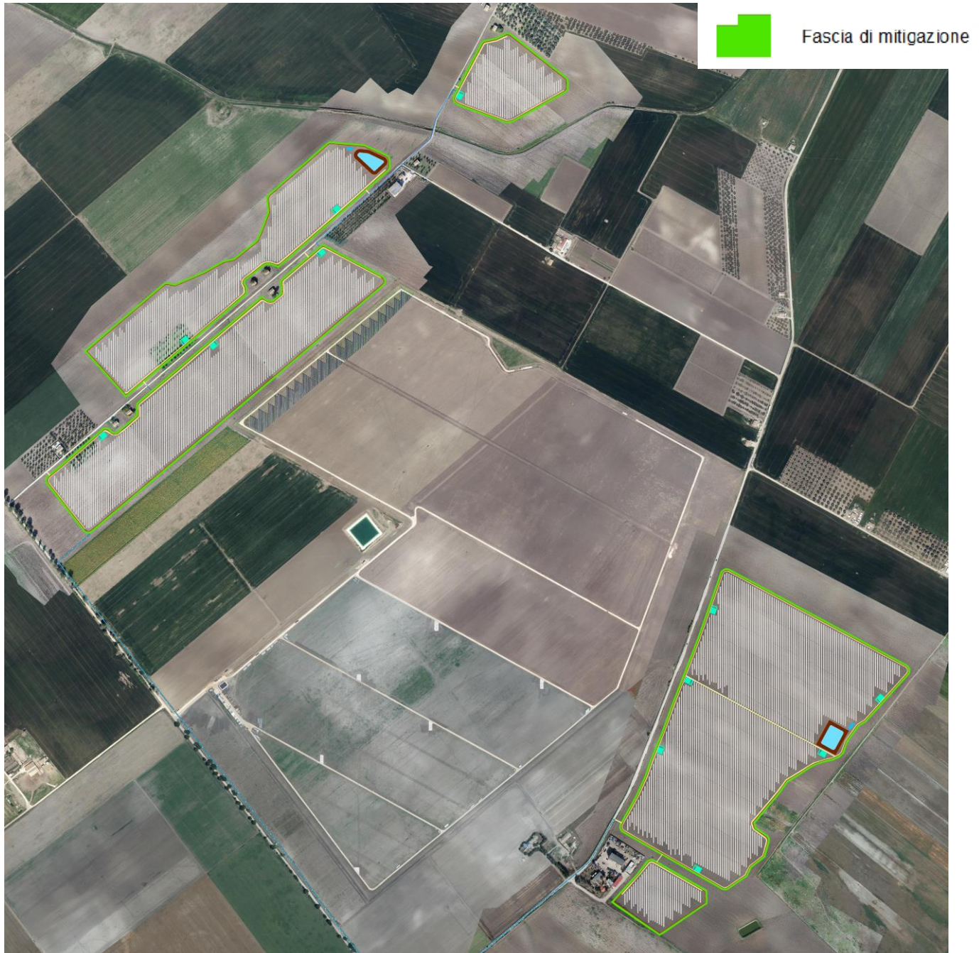
Fig. 21. Localizzazione delle siepi nelle aree dell'impianto agrivoltaico
