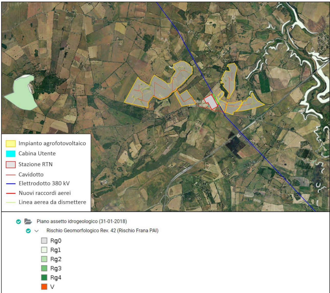
Figura.11 - Aree perimetrate per rischio geomorfologico (fonte geoportale Sardegna, rischio geomorfologico Rev. 42), con sovrapposizione del layout d'impianto
