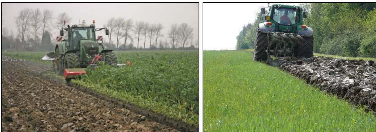
Figura 10.4 - Esempio di pratica del sovescio in pieno campo. Si noti, nell'immagine a sinistra, l'impiego di una trincia frontale montata sulla stessa trattoria per alleggerire il carico sull'aratro portato
