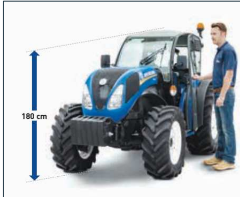
Figura 11.1 - Dimensioni caratteristiche di un trattore da frutteto con cabina ribassata (Fonte: CNH)
