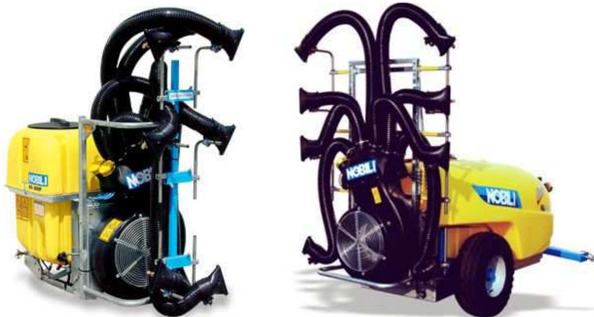
Figura 11.5 - Esempi di turboatomizzatore portato e trainato con getti orientabili per trattamenti su uno o entrambi i lati dell'uliveto (Foto: Nobili S.r.l.)
