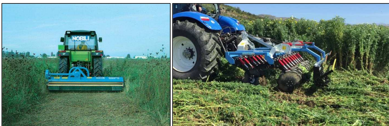
Figura 10.6 - Trinciatura del manto erboso, utilizzando la trincia o direttamente con il frangizolle a dischi (Foto: Nobili S.r.l./Siciltiller S.r.l.)
