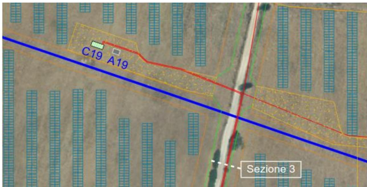
**Figura 4.4: Dettaglio Planimetria dell'impianto agro fotovoltaico con identificazione della sezione 3 per il calcolo del campo elettromagnetico**
