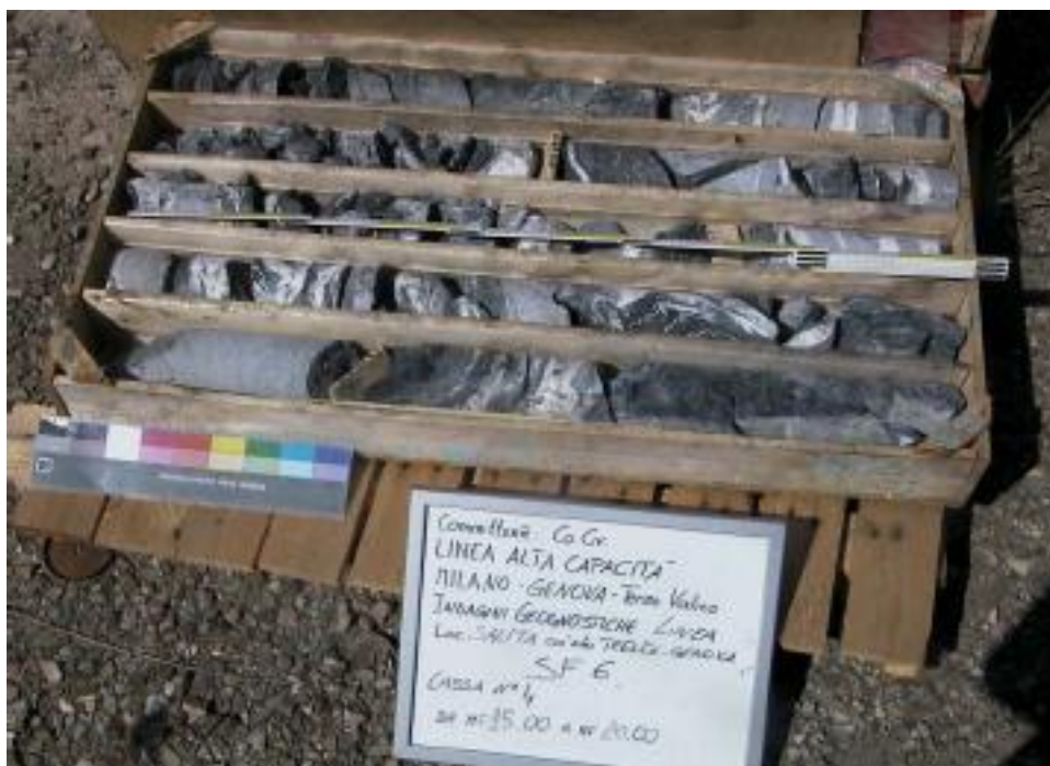
Fig. 3.4 – Esempio di meta-argilliti dal carotaggio SF6
