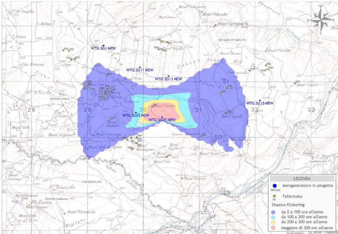
Figura 4 - Mappa di impatto potenziale per l'aerogeneratore WTG SG05 NEW
