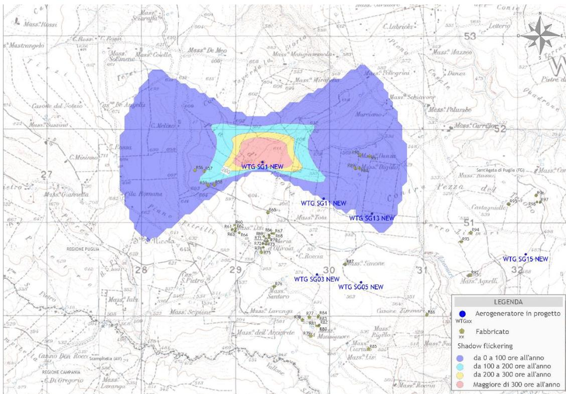
Figura 2 - Mappa di impatto potenziale per l'aerogeneratore WTG SG01 NEW
