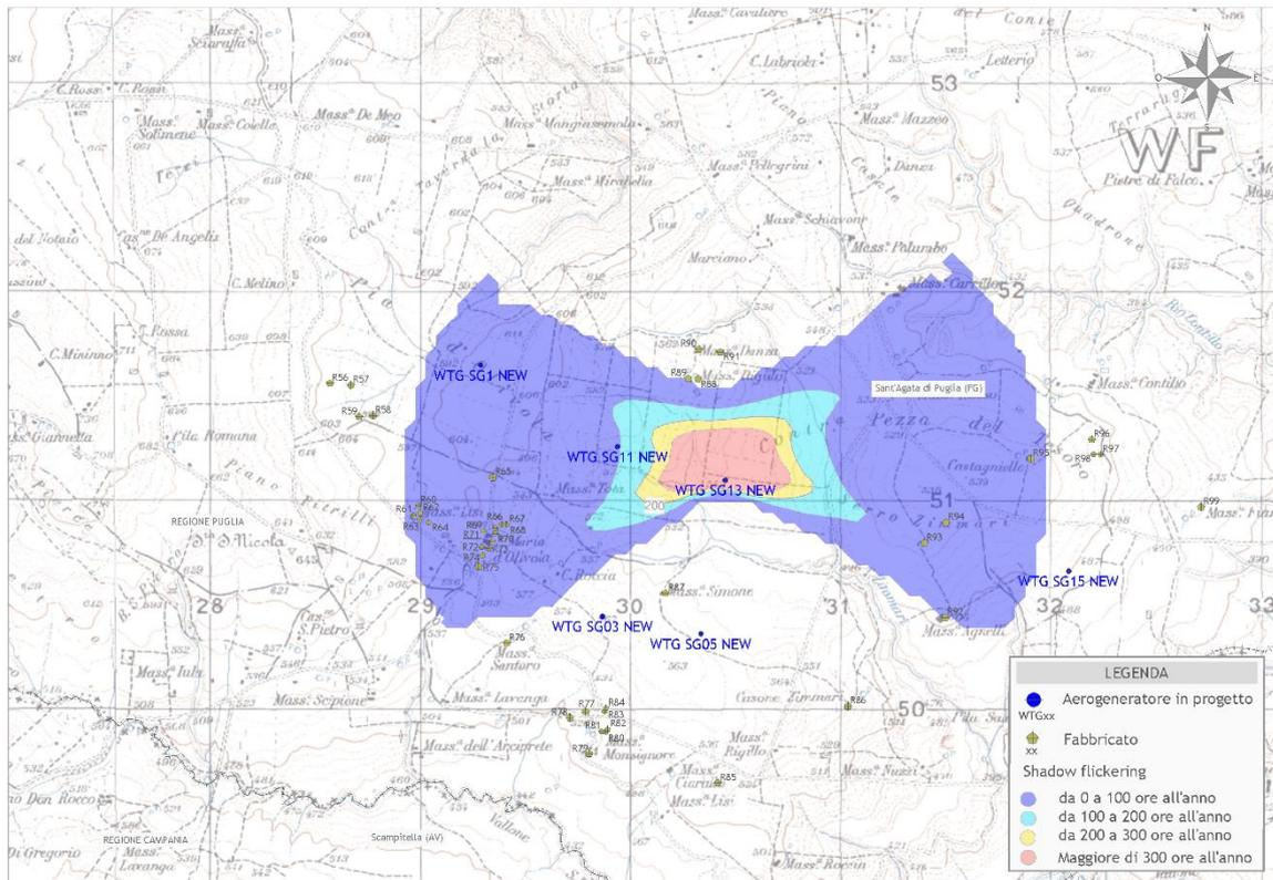
Figura 6 - Mappa di impatto potenziale per l'aerogeneratore WTG SG13 NEW
