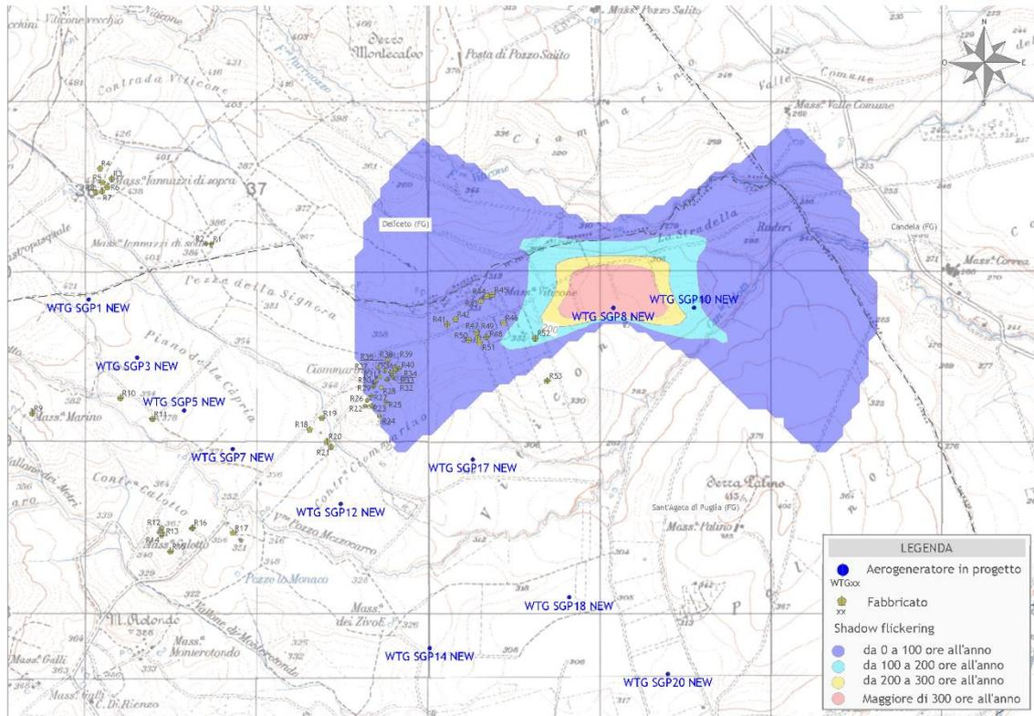
Figura 12 - Mappa di impatto potenziale per l'aerogeneratore WTG SGP8 NEW
