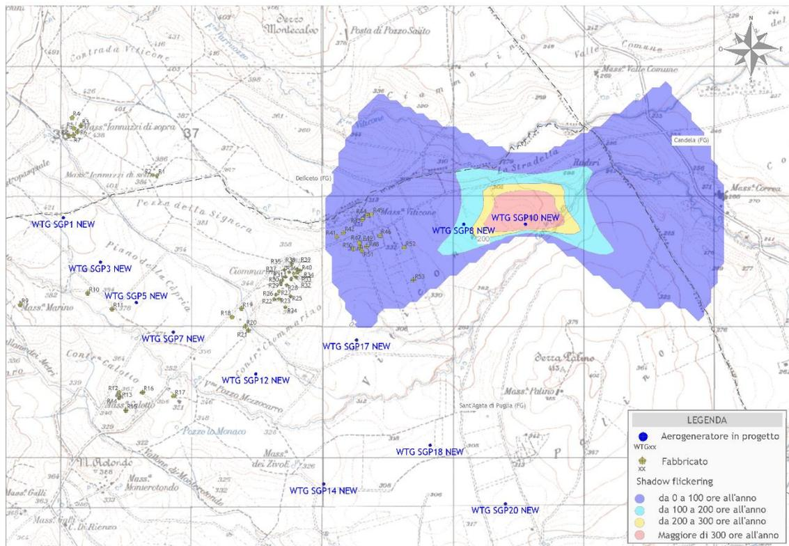
Figura 13 - Mappa di impatto potenziale per l'aerogeneratore WTG SGP10 NEW
