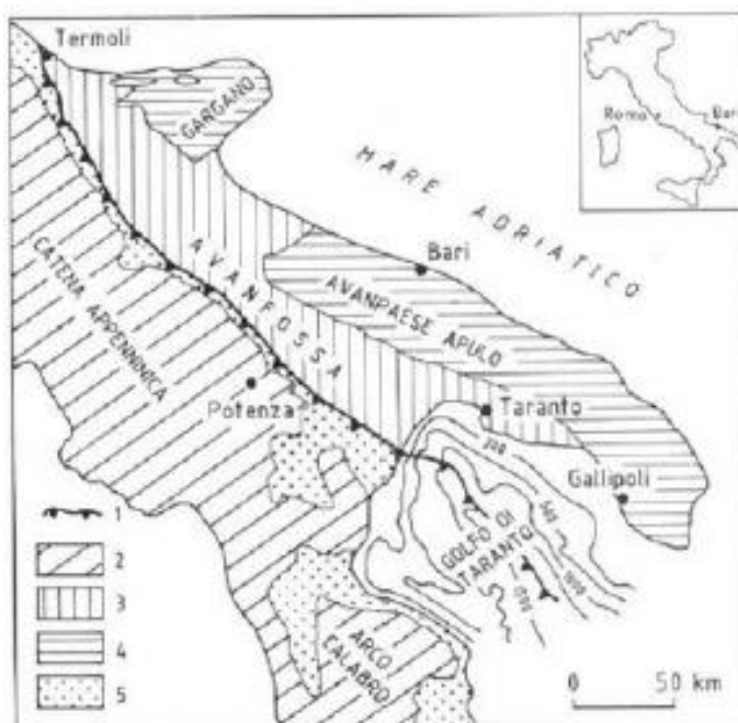
Figura 3 – Schema dei principali domini geodinamici: 1) Limite delle Unità Appenniniche Alloctone; 2) Catena Appenninica ed Arco Calabro; 3) Avanfossa; 4) Avampaese Apulo-Garganico; 5) Bacini Plio-Pleistocenici – Fonte: Zezza et al., 1984)
