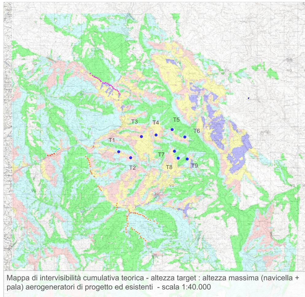
Mappa di intervisibilità cumulativa teorica - altezza target : altezza massima (navicella + pala) aerogeneratori di progetto ed esistenti - scala 1:40.000
