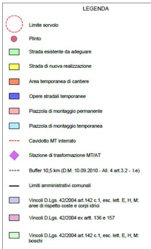
Figura 18: Legenda tavola SGR-SLP-LO.20 "Inquadramento territoriale del parco eolico su IGM - opere permanenti e temporanee – SITAP.
