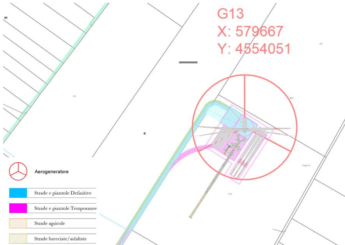
Figura 10- Dettaglio strade di accesso-aree provvisorie e definitive
