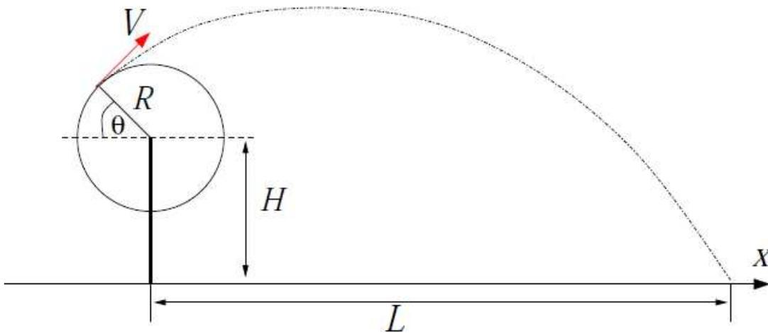
Figura 2: Schema adottato per il calcolo della gittata
