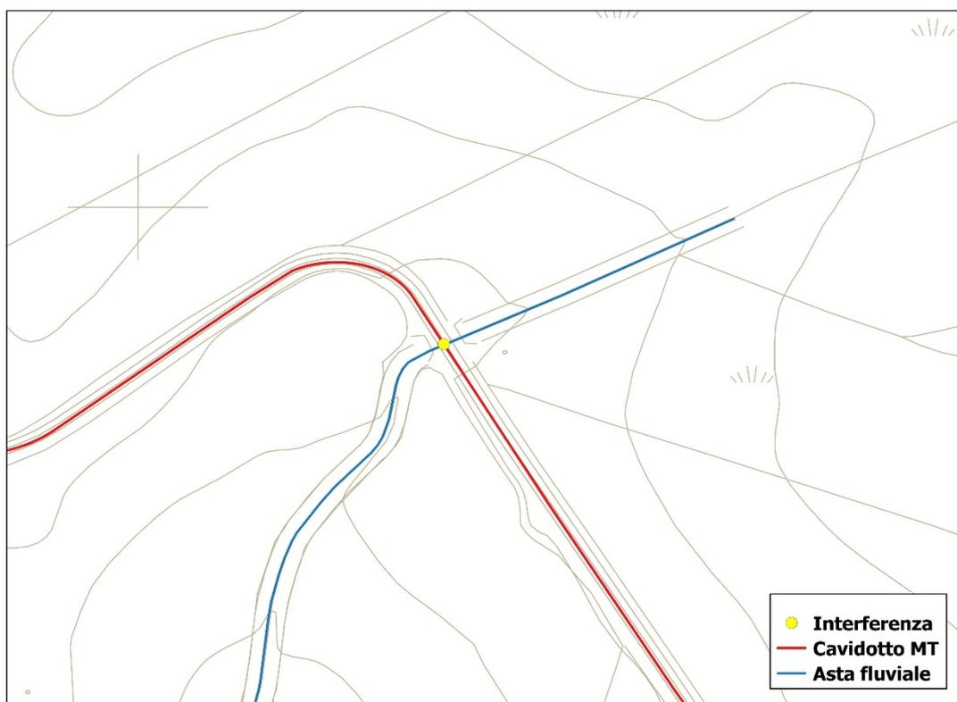
**Figura 3: Dettaglio dell'interferenza su CTR in cui è visibile l'incrocio tra il tracciato del cavidotto MT con il reticolo idrografico.**
