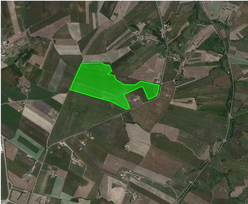
L'impianto fotovoltaico in progetto prevede l'installazione a terra, su più lotti di terreno di estensione complessiva di circa 199.469 m<sup>2</sup> (attualmente a destinazione agricola condotti a seminativo), di pannelli fotovoltaici (moduli) in silicio monocristallino della potenza unitaria di 700 Wp.
