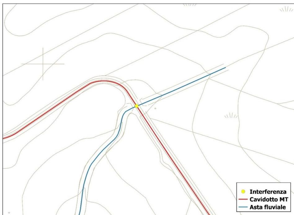
Figura 21 Dettaglio della interferenza su CTR in cui è visibile l'incontro del tracciato del cavidotto MT con il reticolo idrografico
