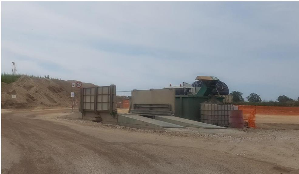
**Figura 11 Esempio di impianto automatico lavaggio ruote mezzi d'opera**
