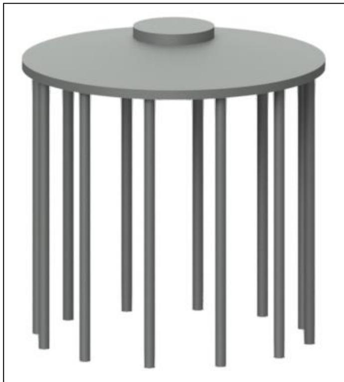
Figura 3: vista tridimensionale della fondazione dell'aerogeneratore
