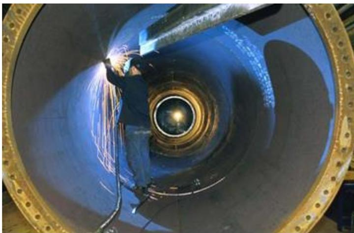
**Figura 15: interno di una torre**
