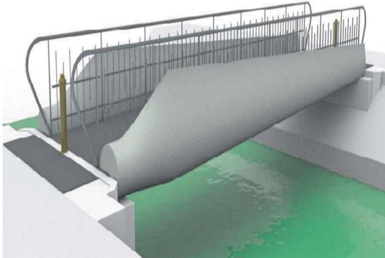
Figura 4 : "Analisi e progettazione di un ponte pedonale con pale eoliche e calcestruzzo FRP dismessi", presentato da Raj Suhail al FRPRCS14, Belfast, Regno Unito, 4-7 giugno 2019.
