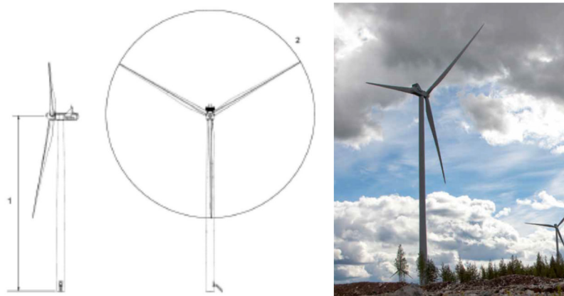
Figura 13: Caratteristiche dimensionali e compositive di un aerogeneratore tipo
