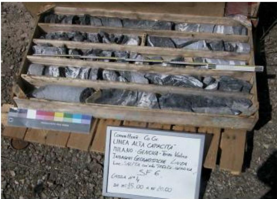
**Fig. 5.4 – Esempio di meta-argilliti dal carotaggio SF6**
