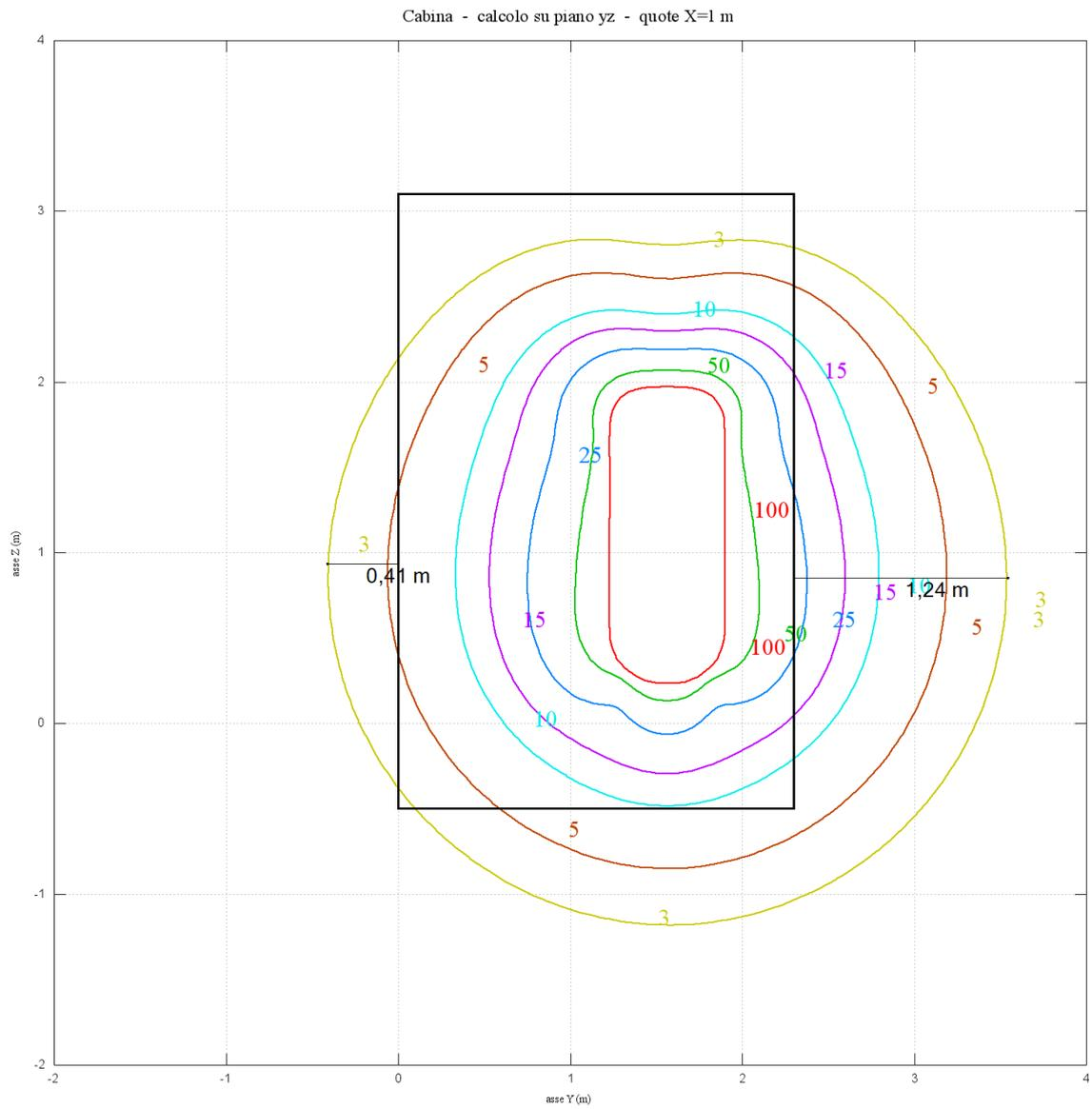
9.2 Curve isolivello induzione magnetica nell'intorno della cabina di sottocampo tipo.
