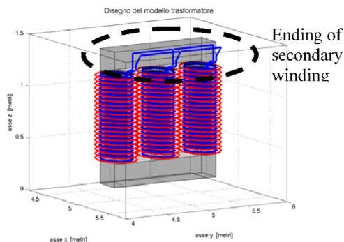
Fig. 14: Connessioni elettriche considerate ai lati BT.
