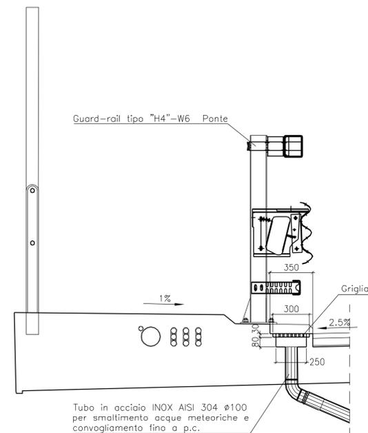
SEZIONE B-B (in corrispondenza del bocchettone di scarico)
