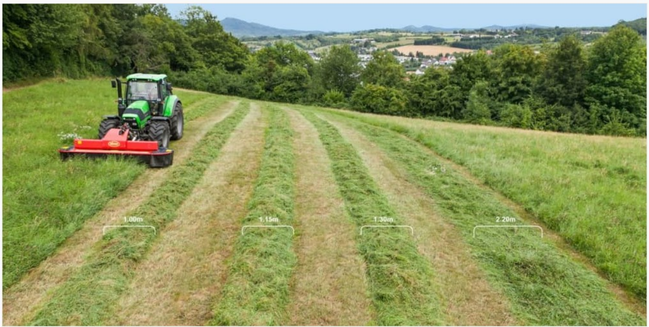
Figura N. 6: Immagine della falciatrice anteriore e larghezze delle andane realizzabili
