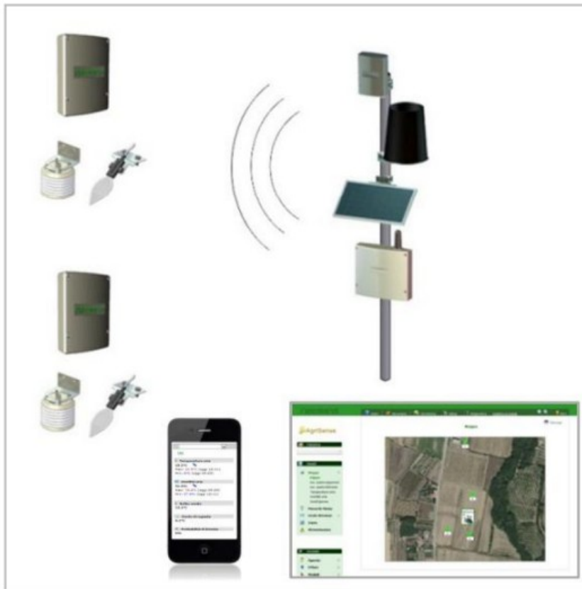
Figura 1: stazione principale e sensori meteo climatici.
