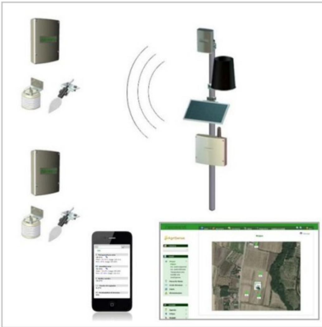
Figura n. 6: Stazione principale e sensori meteo climatici.
