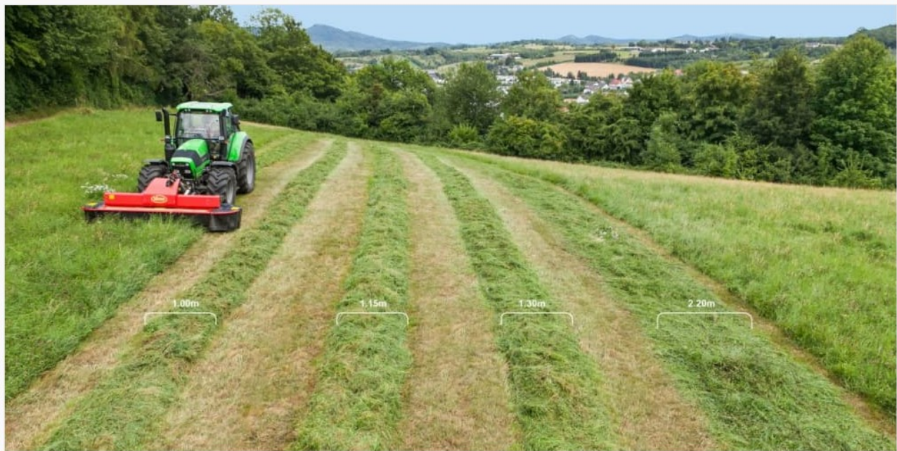
Figura N. 5: Immagine della falciatrice anteriore e larghezze delle andane realizzabili
