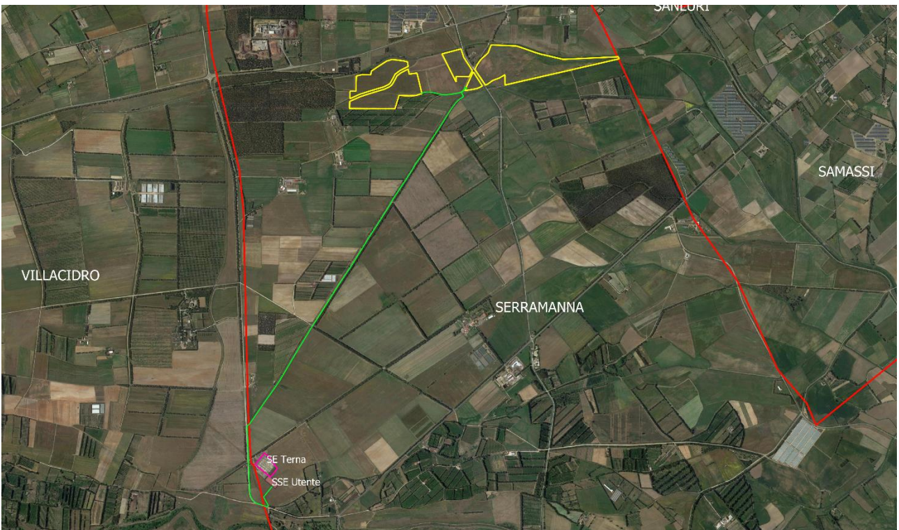
Figura 6 - Area di impianto (in giallo), cavidotto MT a 36 kV (in verde), SSEU (in rosa) e SE Terna (in viola)
