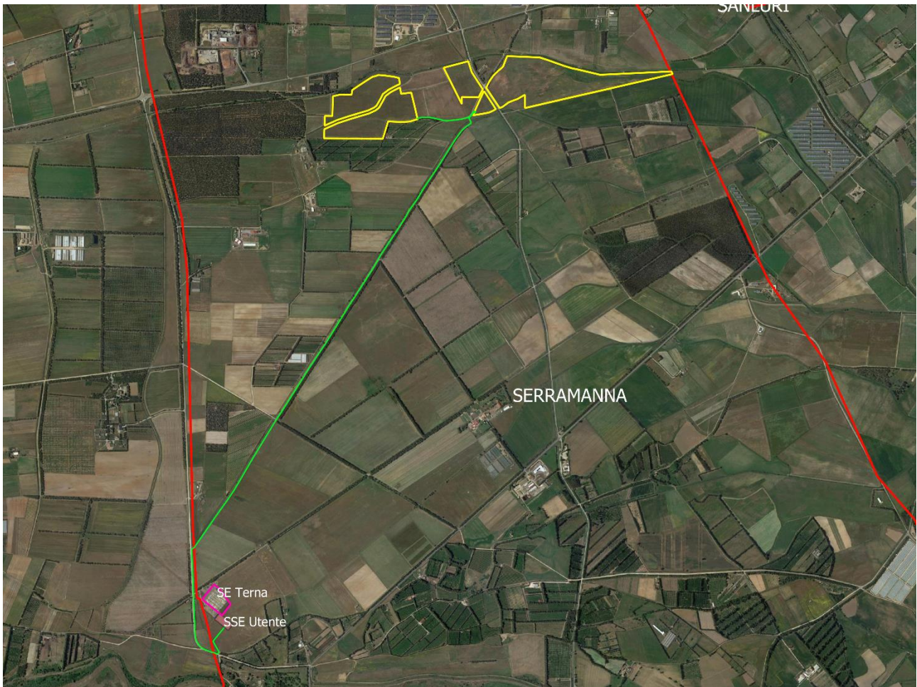
Figura 13 - Area di impianto (in giallo), sviluppo del cavidotto (in verde) e limiti comunali (in rosso)
